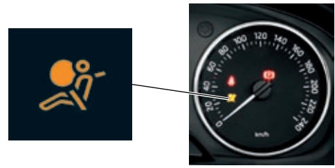
Kontrollleuchte des Airbagsystems auf der Instrumententafel
